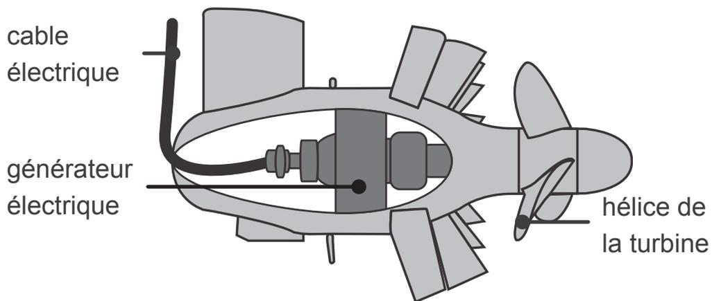
Le bulbe de l'usine marémotrice est un générateur électrique qui permet de produire de l'énergie électrique à partir d'une autre forme d'énergie.
