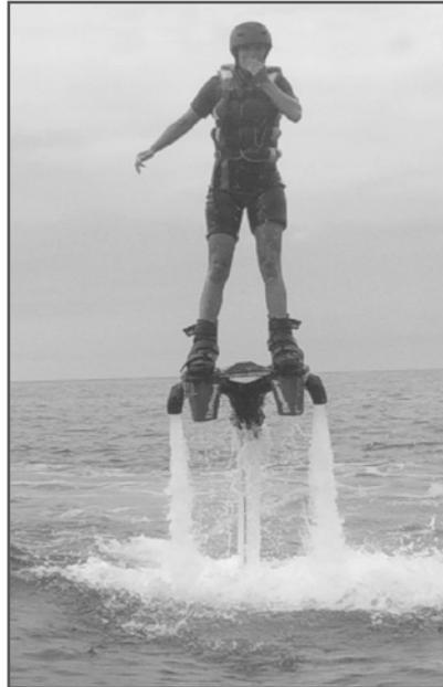
Le sportif est debout sur une planche équipée d'une pompe. Cette pompe aspire de l'eau et simultanément la rejette en un puissant jet dirigé vers le bas.
