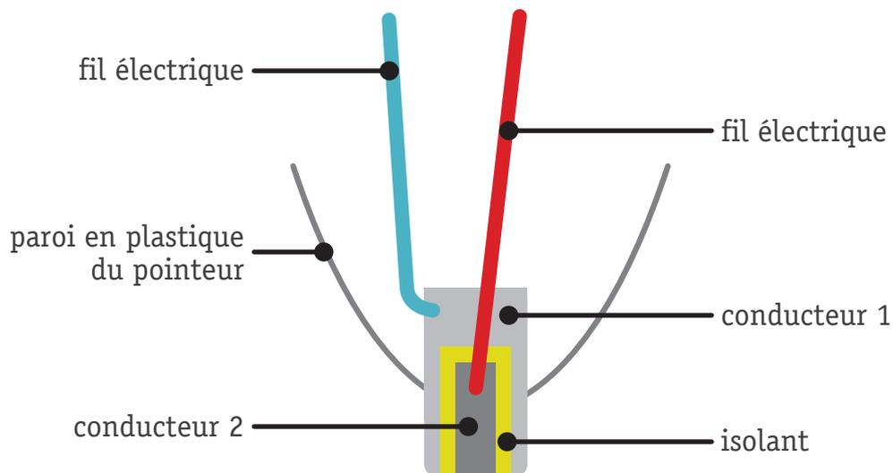
**EXPLIQUE** pourquoi la lampe s'allume quand l'embout du pointeur est en contact avec le disque noir correspondant à une réponse correcte.
